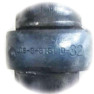
建設省告示第1463号 適合溶接継手工法
